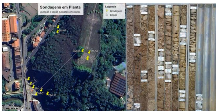
Figura 3: Locação dos furos de sondagem e exemplo de caixa de testemunho.
