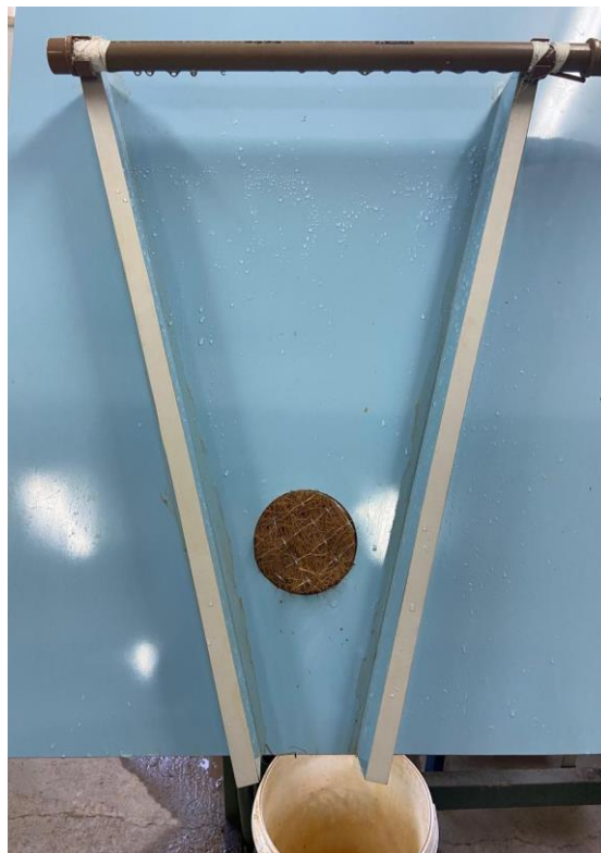
Figura 3. Execução do ensaio de Inderbitzen na amostra com a biomanta de fibra de coco.
