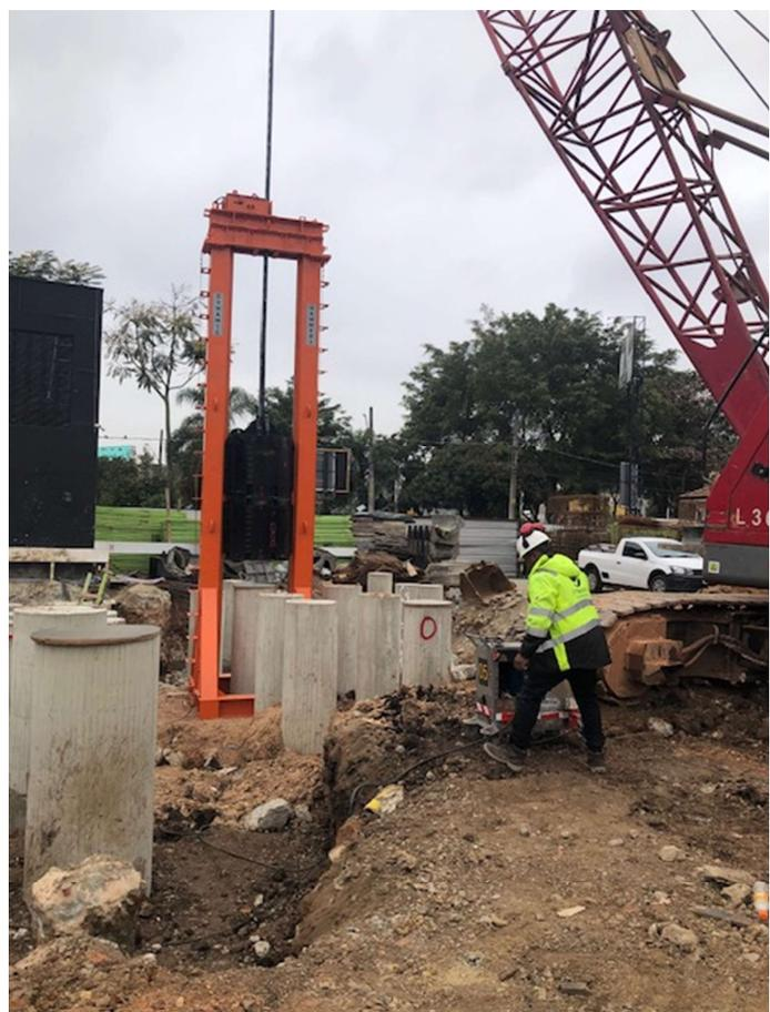
Figura 2: Equipamentos de queda livre usados nos testes da primeira e da terceira obra aqui citadas
