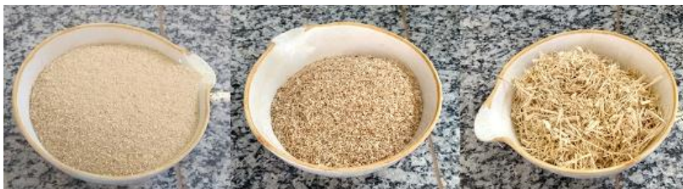
Figura 3: Amostras da fibra- da esquerda para direita -menor que 0,0425 cm; 0,5 cm e 1,0 cm.
