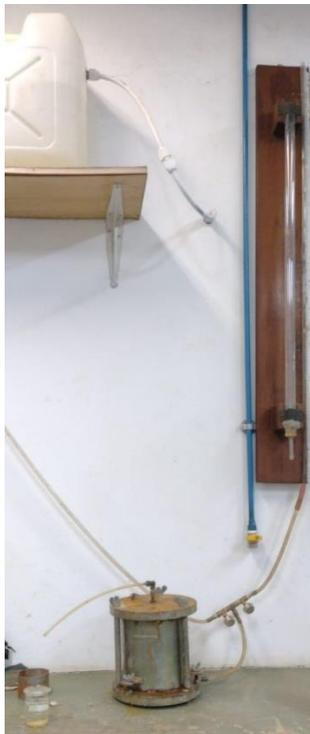
Figura 1 – Sistema de montagem dos ensaios de permeabilidade
