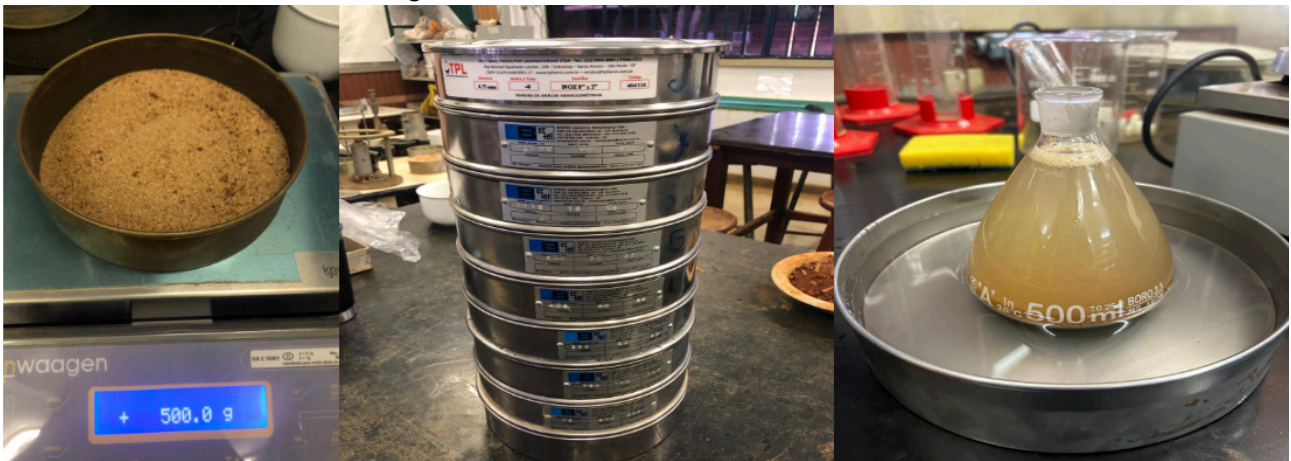
Figura 5. Materiais utilizados para o ensaio da granulometria e ensaio do picnômetro.
