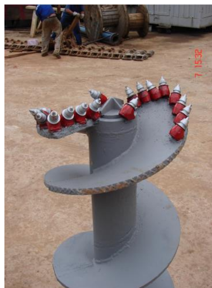
Figura 5. Ponteira de trado para execução de pré-furo (Autor, 2015)
