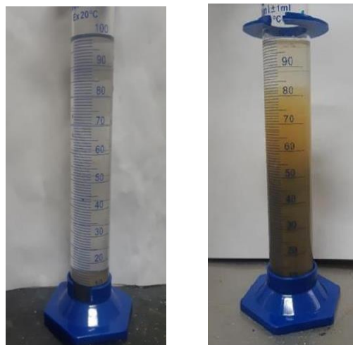
Figura 4. FSI para solo B com substituição de 12,5% CBCA (a) proveta com solo e querosene (b) proveta com solo em água.
