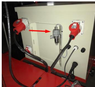
Figura 6 – Exemplo do posicionamento do sensor de temperatura e pressão nos sistemas de monitoramento. (Fonte: Própria do Autor.)
