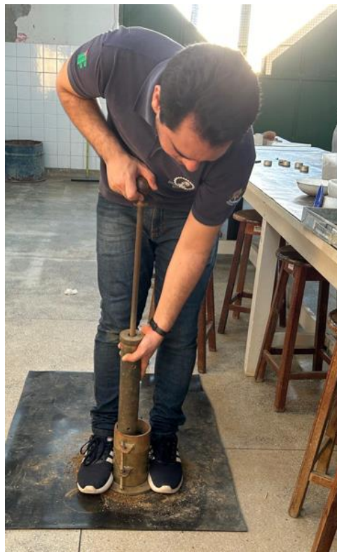
Figura 3. Realização do ensaio de compactação.
