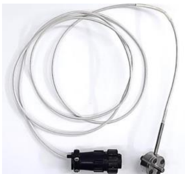
Figura 2. Célula de carga de 5000 N utilizada nos ensaios de CPT
