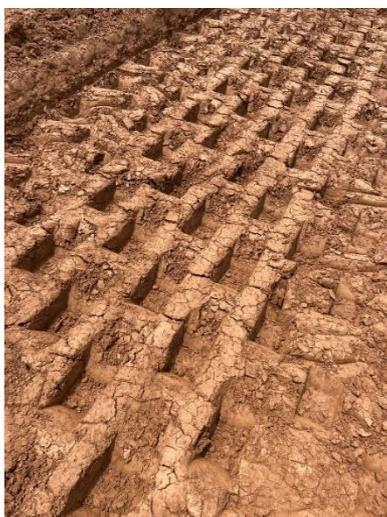
Figura 6. Rejeito com 200g/t pós compactação.
