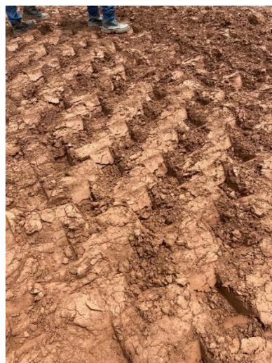
Figura 7. Rejeito com 500g/t pós compactação.
