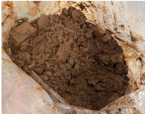
Figura 1. Rejeito filtrado de minério de ferro na umidade de campo.
