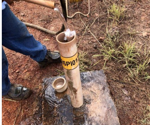
Figura 2 – Execução de Teste de Vida em piezômetro.
