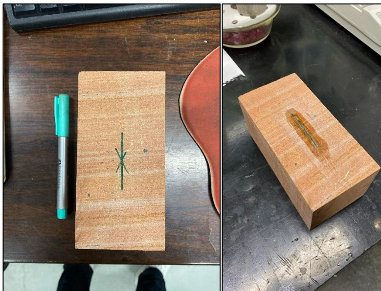
Figura 3. Instrumentação do corpo de prova – Strain gauges.
