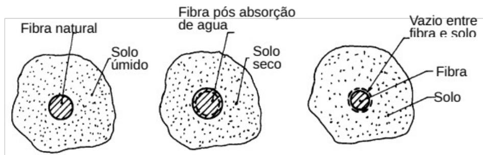
Figura 1. Representação esquemática da perda de interação matriz reforço devido as variações dimensionais da fibra resultantes de ciclos de umedecimento e secagem do solo
