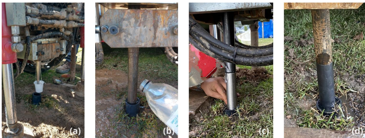
Figura 5. Etapas que antecederam o início do ensaio conservação da saturação do elemento poroso da sonda piezométrica (a) e (b) e piezocone (c) e (d).
