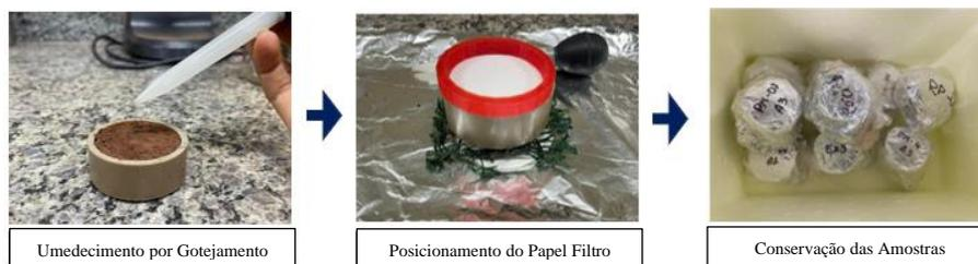
Figura 2 – Etapas de tratamento do anel filtro (saturação, posicionamento e armazenamento)
