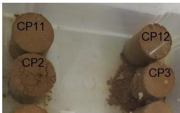
Figura 4. CPs com 2% de Cal antes da ruptura
