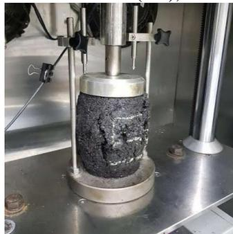
Figura 4. Ensaio de Flow Number.
