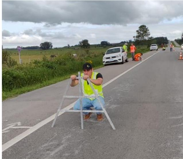
Figura 6. Verificação do afundamento de trilho de roda por meio da treliça.
