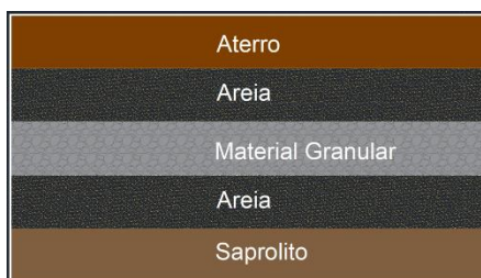
Figura 6. Esquemática da posição dos materiais que atendem ao critério de pipig (Elaborado pelo Autor).
