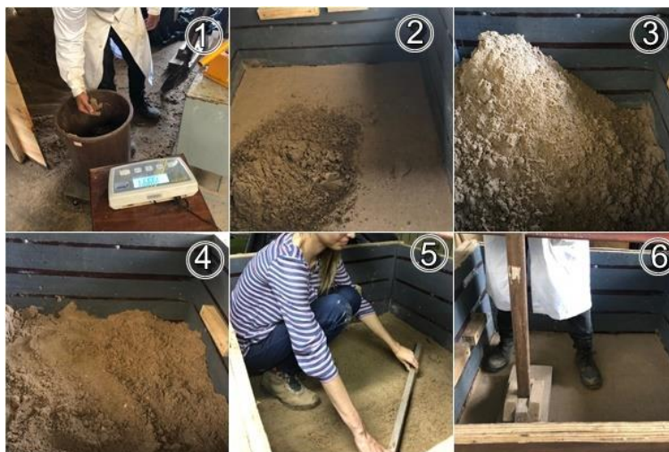
Figura 4. Preenchimento da caixa de ensaios: (1) determinação da massa do solo, (2) – (3) lançamento do solo em camadas, (4) distribuição do solo, (5) nivelamento e (6) compactação do solo.
