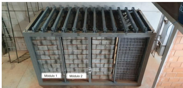
Figura 3. Protótipo finalizado com 4 diferentes configurações construtivas.
