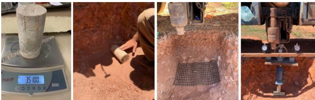
Figura 5. Detalhes da montagem das provas de carga.
