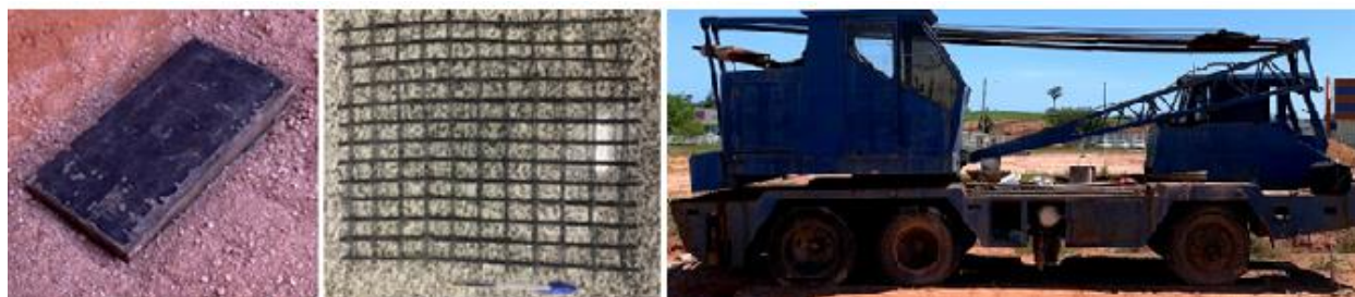
Figura 3. Placa metálica rígida, geogrelha e sistema de reação utilizados nas provas de carga.
