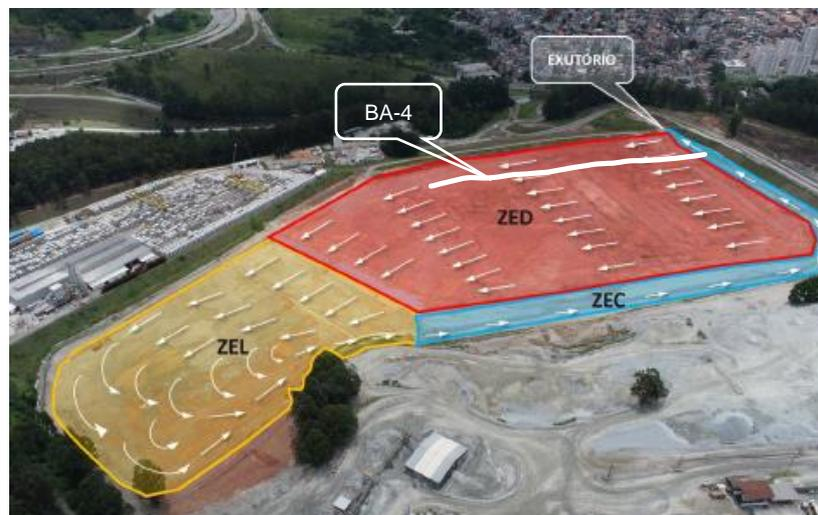
Figura 1- Áreas de dinâmica de escoamento superficial e direcionamento das águas pluviais.
