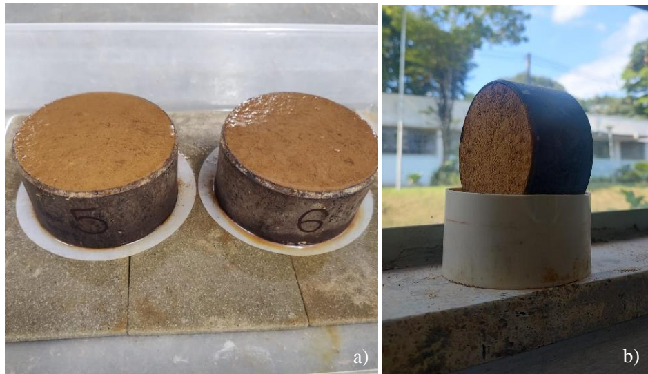
Figura 2. Amostras indeformadas em processo de A) saturação e B) secagem.
