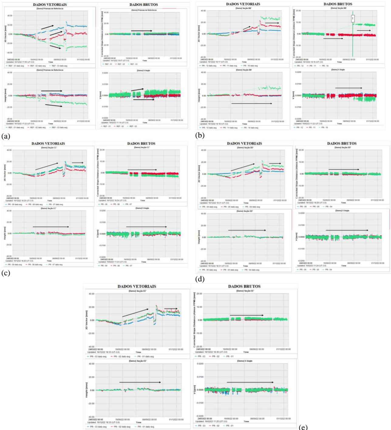
Figura 5. Gráficos de monitoramento dos prismas de monitoramento da Seção AA' (a), BB' (b), CC' (c), DD' (d) e EE' (e), da ECJ-CCR
