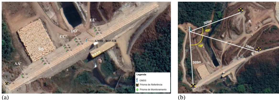
Figura 2. Em (a), localização dos prismas de monitoramento da ETR, sessões de análise e antena rover da GNSS da ECJ-CCR. Em (b), Geometria da rede geodésica para monitoramento por ETR da ECJ-CCR.
