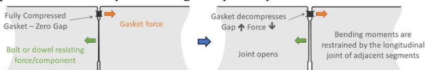
Figura 4. Equilíbrio de forças horizontais em juntas circunferenciais
