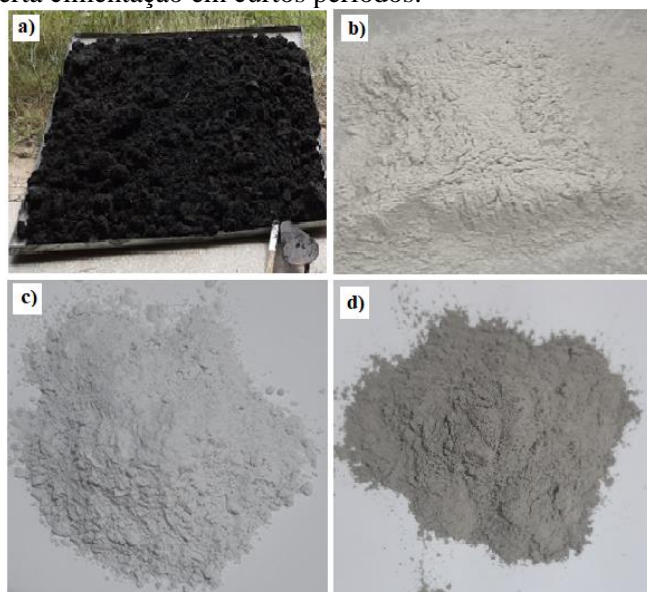
Figura 1. Materiais utilizados na pesquisa: a) solo argiloso orgânico; b) escória de alto forno; c) cal de carbureto; e d) cimento Portland CPV.
