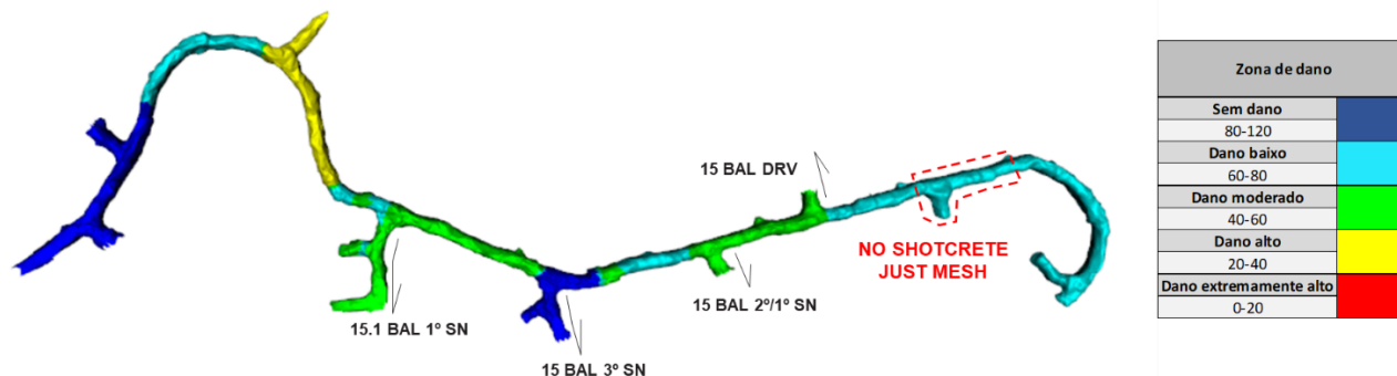
Figura 6. Atualização do mapeamento de danos no 15 BAL RP (Agosto/23).
