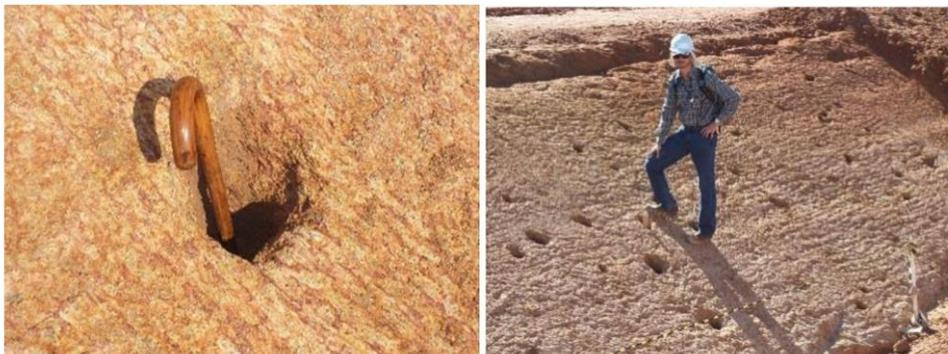
Figura 1. Canaliculos encontrados na trincheira exploratória do Dique 19B, em Belo Monte.
