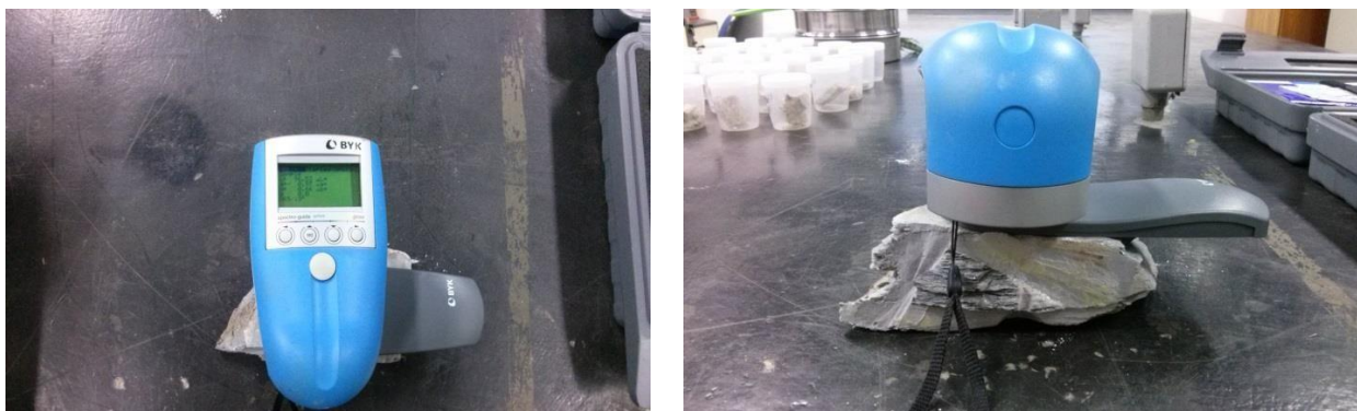
Figura 2. Detalhes do colorímetro durante o teste da cor na matriz da rocha filítica (W2).
