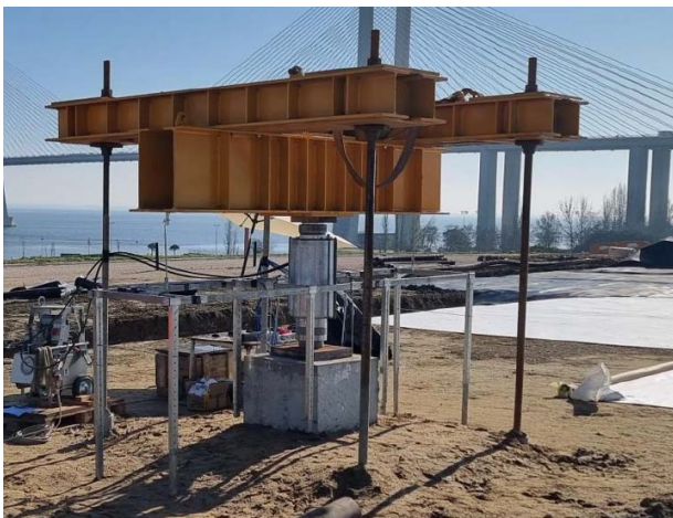
Figura 12 - Ensaio de carga de compressão.
