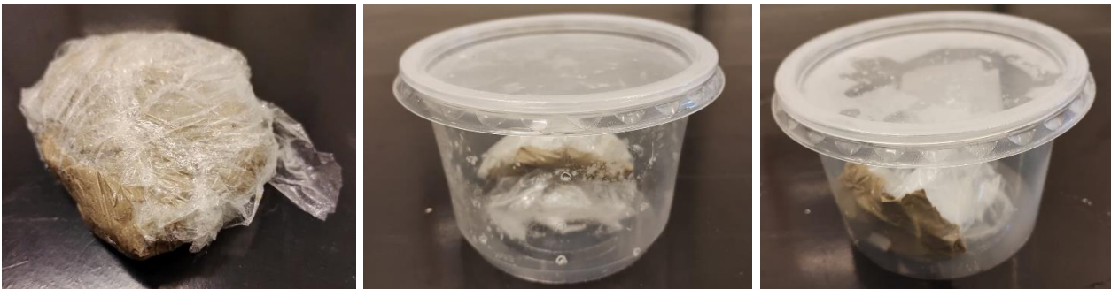
Figura 1. Métodos de armazenamento das amostras: a) envoltas em plástico filme PVC; b) envoltas em plástico filme PVC e armazenadas em um recipiente plástico furado; c) envoltas em plástico filme PVC e armazenadas em um recipiente plástico fechado.
