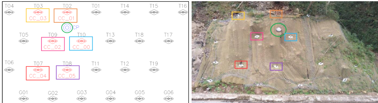
Figura 3. Vista frontal esquemática do talude com a posição dos dispositivos.
