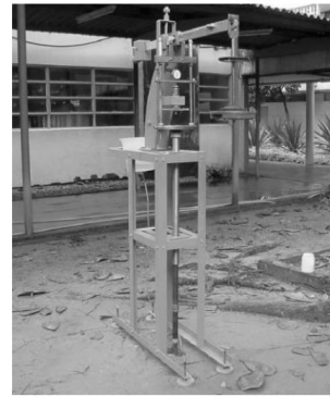
Figura 5. a) Ensaios de placa (Costa et al. 2003); b) Expansocolapsômetro (Ferreira e Lacerda 1993).
