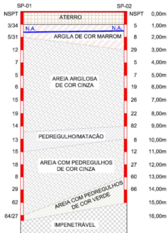
Figura 2. Perfil Geotécnico da área de estudo
