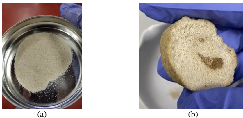
Figura 4. Comparação entre as amostras tratadas, durante 29 dias, com (a) água destilada e (b) B4 a 1,5% e uso de DMEM.
