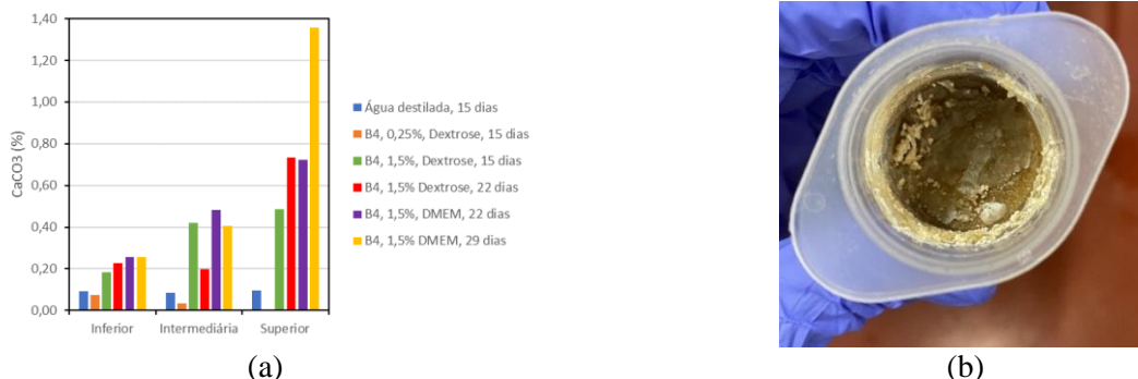
Figura 3. (a) Distribuição de \text{CaCO}_3 nas diferentes camadas da amostra, e (b) Presença de biofilme na parte superior de uma amostra tratada durante 22 dias com B4 a 1,5% e uso de DMEM.
