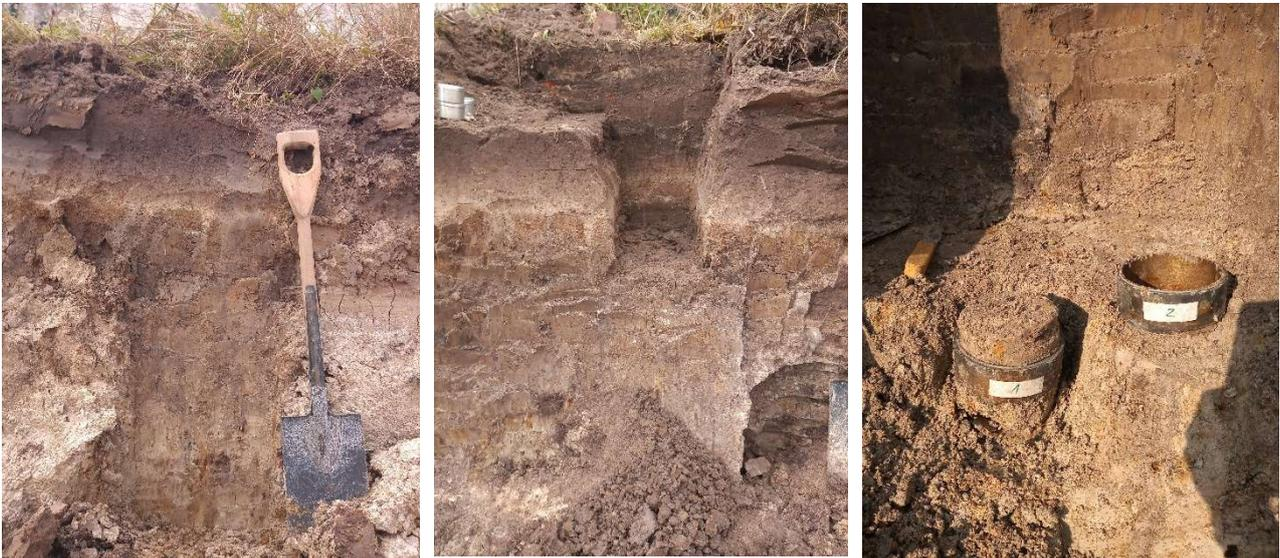
Figura 2. Limpeza e preparação do perfil (a e b) e coleta das amostras indeformadas (c).
