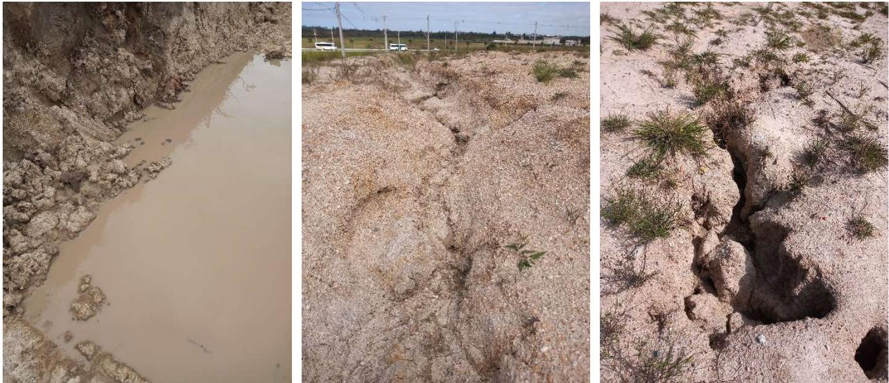
Figura 4. Coloides em suspensão no horizonte B (a); horizonte C com processo de erosão laminar (b) e erosão interna (c).
