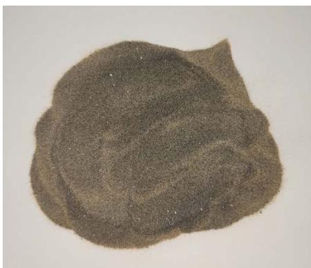
Figura 1. Rejeito de mineração de ferro in natura.
