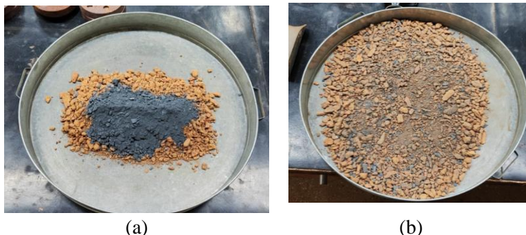
Figura 1. (a) Amostra de solo + 20% resíduo no teor de umidade higroscópica; (b) Amostra de solo no teor de umidade ótima.
