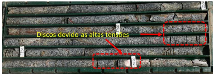
Figura 3. Testemunho geotécnico DDHRSP – 14A21 e discos devidos a altas tensões – Litologia granodiorito
